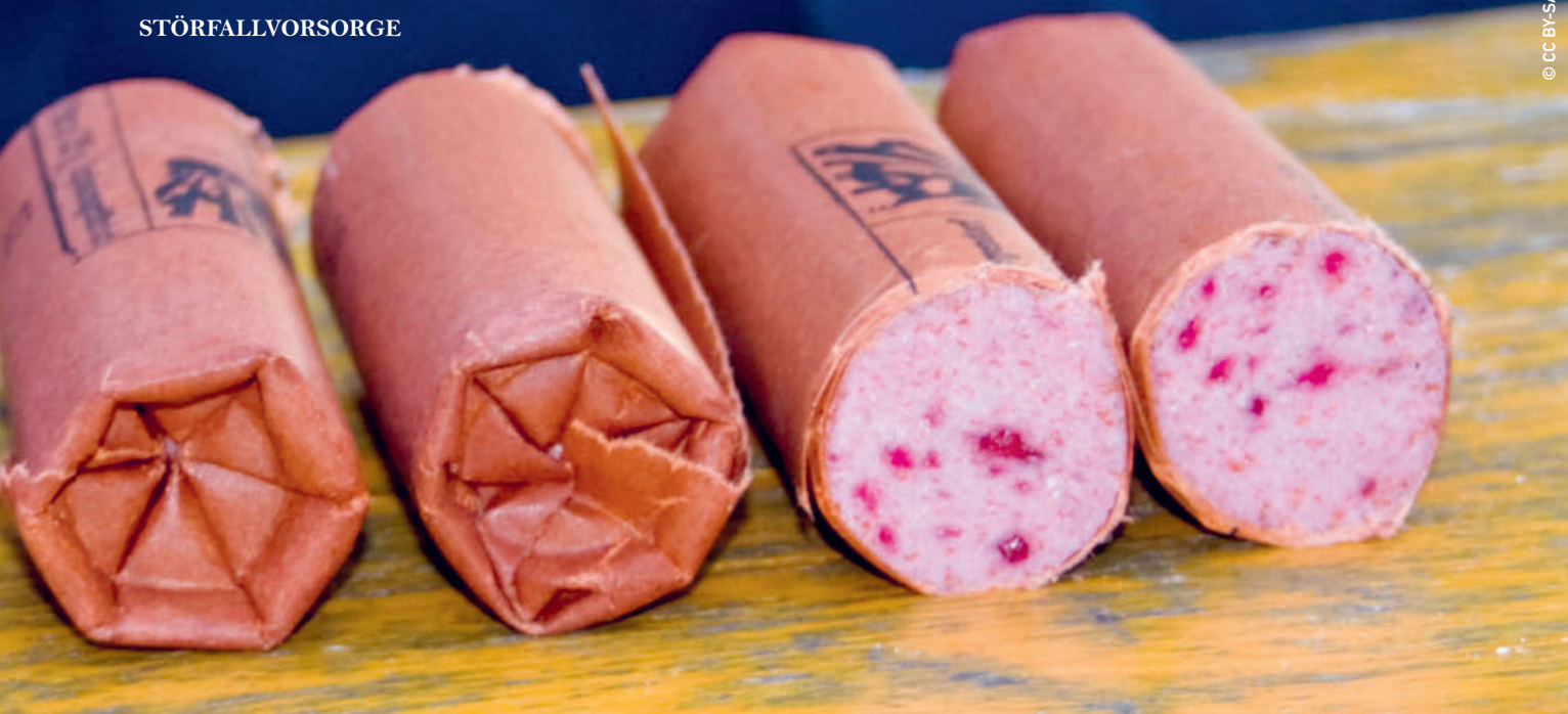
Aufgeschnittene 125-Gramm-Patronen des gelatinösen Gesteinsprengstoffs Eurodyn 2000 (Hersteller: Orica).
